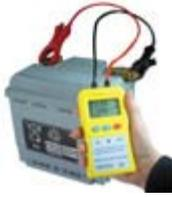
Pour vous aider à détecter les défauts d'une batterie, on trouve sur le marché un analyseur de batterie électronique (<http://www.selectronic.fr> > encoder dans la zone de recherche l'article BCD2112) qui va mesurer une série de paramètres de la chère boîte noire.
