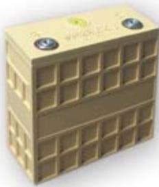
Batterie de 12 V- 20 Ah - 180mm x 168mm x 75mm – poids 3,3 kg – Courant de charge max : 60 A - Courant de décharge constant : 60 A - Courant de décharge instantané : 200A
