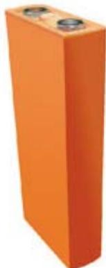
Batterie de 3,2 V- 90 Ah - 145mm x 220mm x 68mm – poids 3,0 kg – Courant de charge max : 270 A - Courant de décharge constant : 270 A - Courant de décharge instantané : 900A
