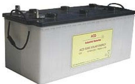
Sous ces latitudes, la batterie est en permanence à 30°C, favorisant une évaporation naturelle. La vie à bord sollicite fort les batteries, puisqu'elles doivent être rechargées tous les jours (cyclage + élévation de la T° lors de la charge > évaporation et dégazage). Il est impératif de vérifier régulièrement le niveau de l'électrolyte et de rajoutée de l'eau distillée si nécessaire.
